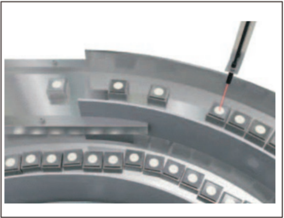
检测LED灯珠的正反面
